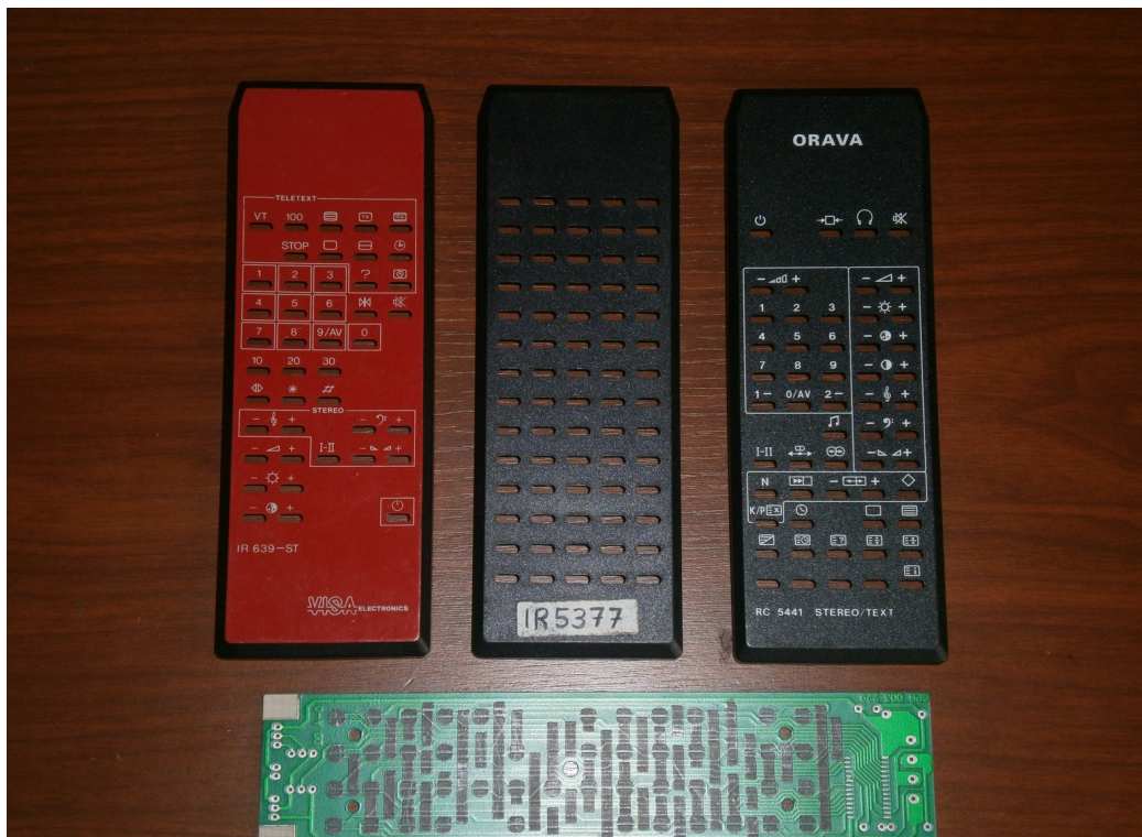
Zde například ovladače firmy Visa - vlevo originál, napravo již s nástřikem Orava
